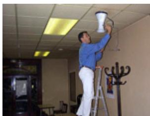
**Bouche d'extraction** : mesure du débit extrait à l'aide du cône de mesure avec anémomètre fil chaud (Café-Bar)
