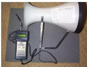
**Cône de mesure de débit** (avec anémomètre) : pour les mesures de débits aux bouches. Cône de 20cm de diamètre (bouches type VMC : logements, sanitaires...).
