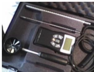
**Anémomètre à fil chaud ou à moulinet** : pour la mesure du débit en conduit ou la mesure du débit soufflage/extraction à certaines grilles
