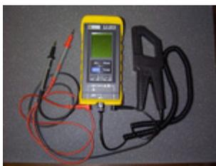
**Appareil de mesure de puissance électrique** : pour la mesure de la puissance absorbée par les moteurs (ex. ventilateurs) (mesure aussi : tension, intensité, cos  $\varphi$ )
