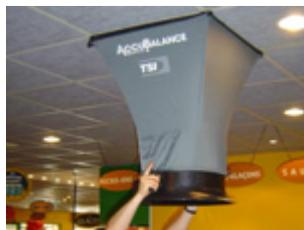
**Ballomètre ou hotte modulable** : pour les mesures de débits aux bouches de grandes tailles et de dimensions variées (notamment en tertiaire).
