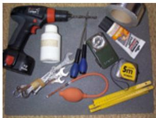
**Petit matériel** : fumigène (visualisation des écoulements d'air, des fuites,...), perceuse, bouchons, mètre, tournevis et clés, adhésif alu...
