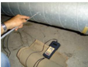
**Conduit** mesure du débit d'air à l'anémomètre à fil chaud
